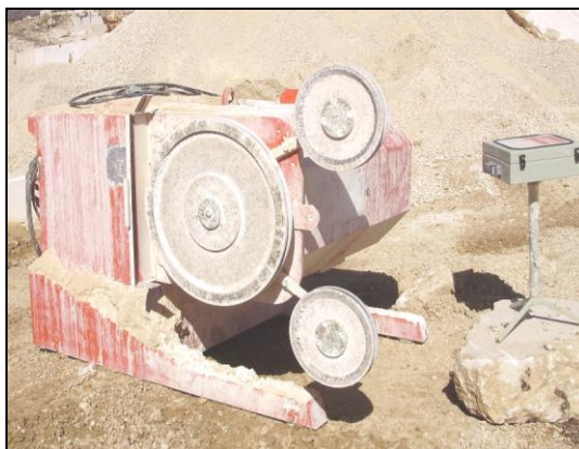
Слика бр. 5. Машина за резање камена са дијамантном жичном пилом “SKYSTONE“
