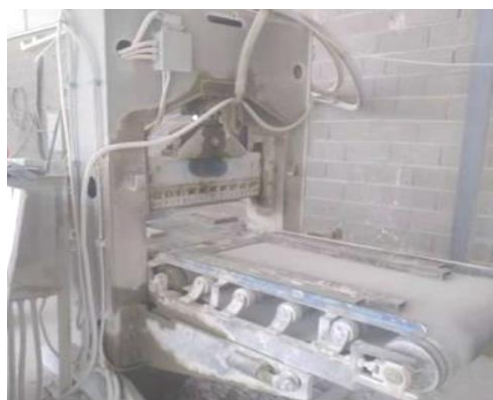
Слика бр. 17. Хидраулична преса за цијепање камених греда на камене блокове
