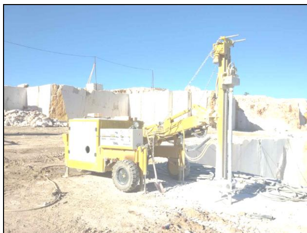
Слика бр. 8. Покретна компресорска бушилица
