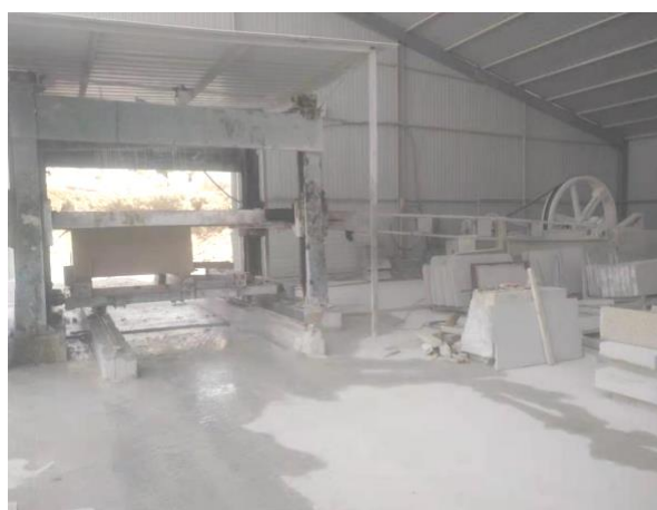
Слика бр. 13. Машина за резање камена са 8 пила – клатна тестера
