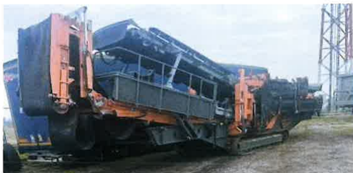
Slika 14. Mobilna separacija RTS 514 3-deck
