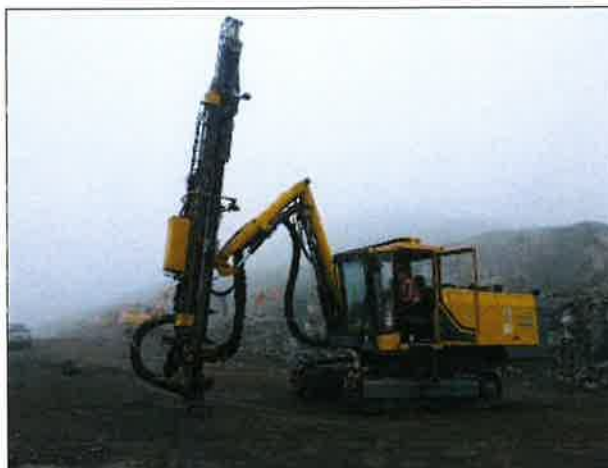
Slika 9. Izgled bušaće garniture Atlas Copco ROC F7 HC-11
