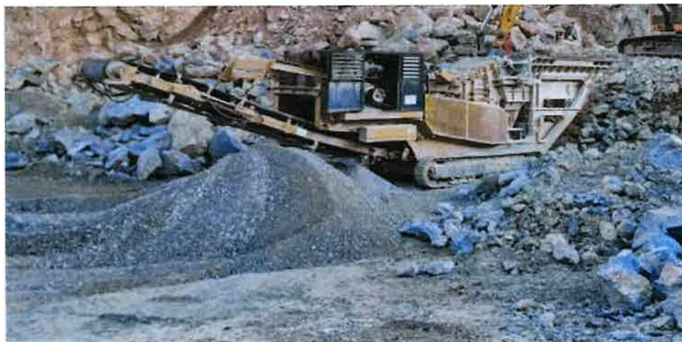
Slika 13. Mobilno drobiljno postrojenje HARTL 504
