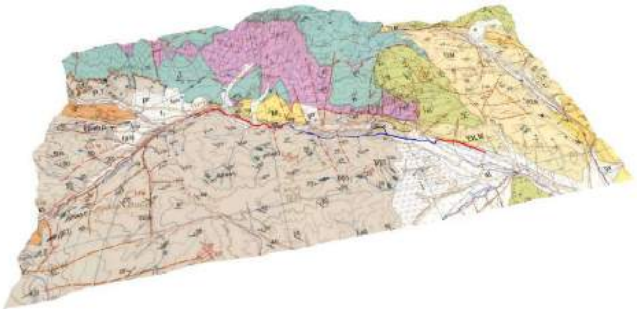
Slika 75 Geološka građa šireg terena (OGK list Zenica, M 1 : 100 000) u stacionažnom rasponu od km 5+724,83 do km 11+430,29
