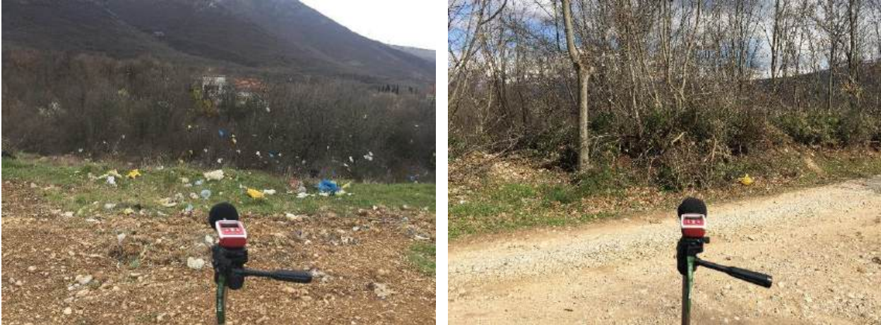
Slika 51. Mjerenje buke ne predmetnoj lokaciji
