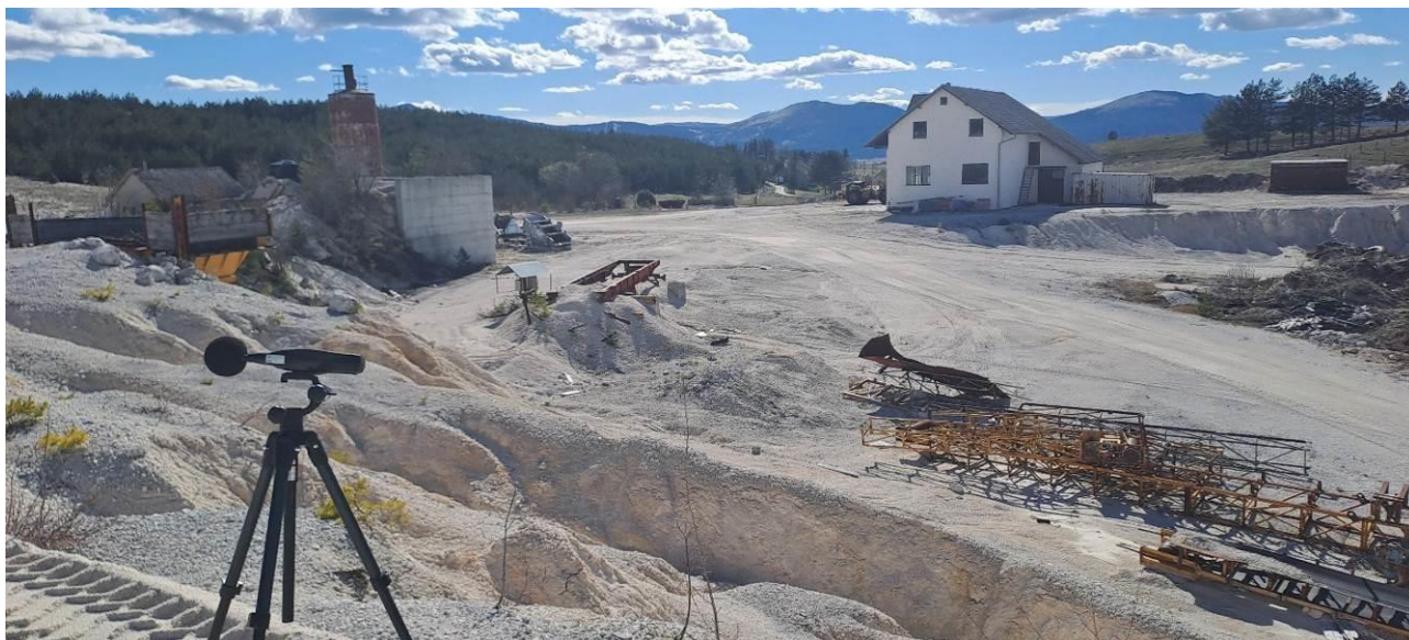
Slika 87 Mjerenje razine emisije buke na prostoru postojeće separacije dolomita
