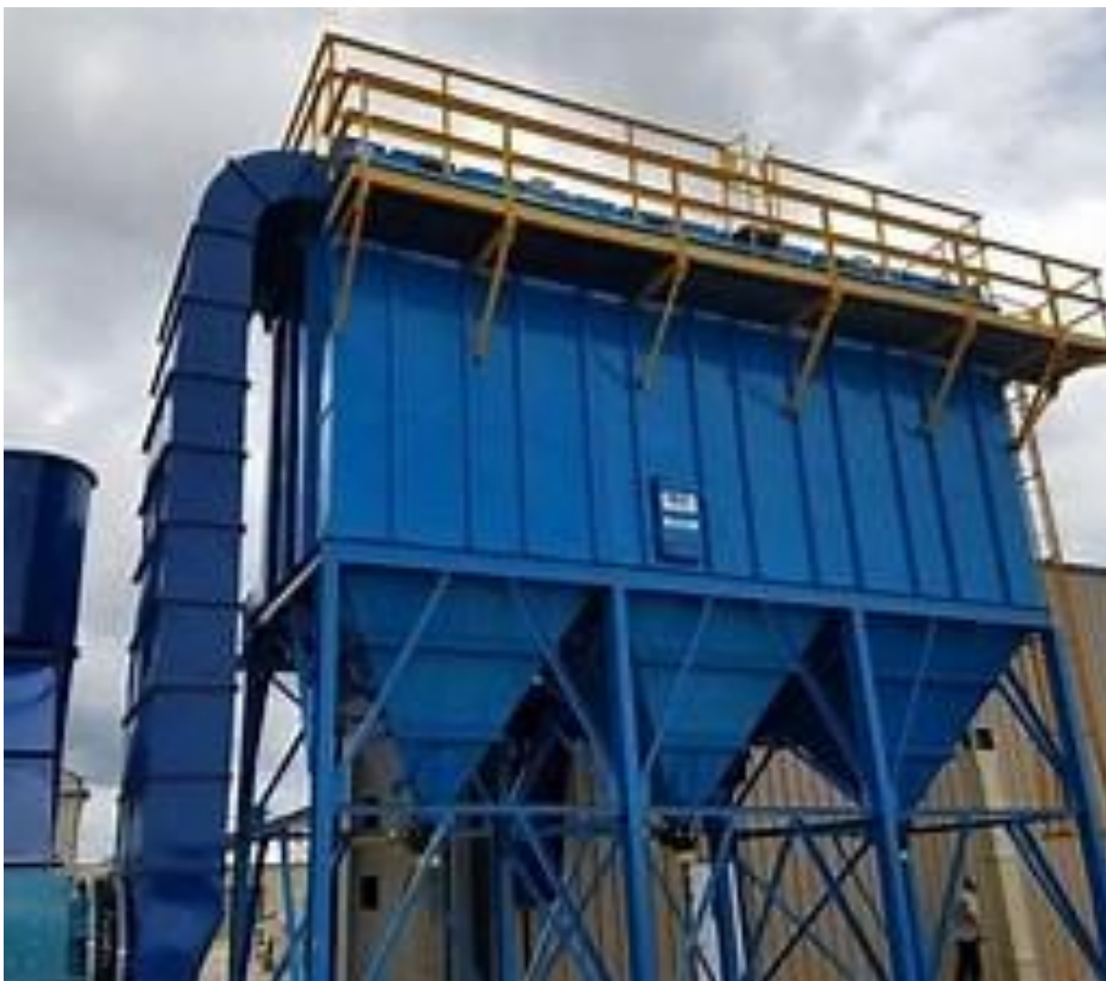
Slika 30 Izgled industrijskog vrećastog filtera u kućištu
