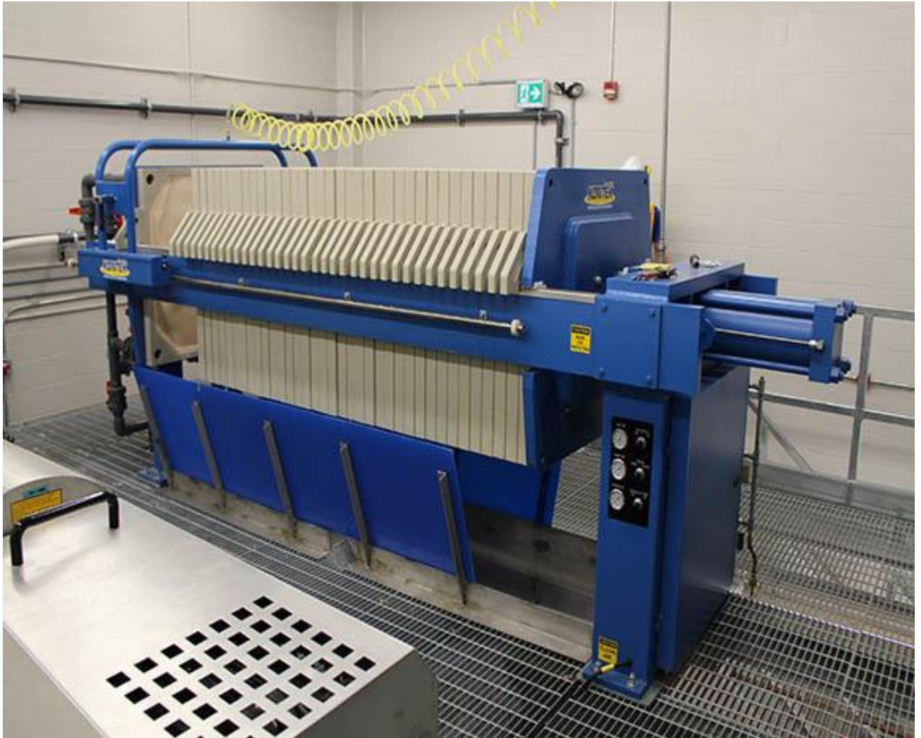
Slika 31 Izgled industrijske filter prese
