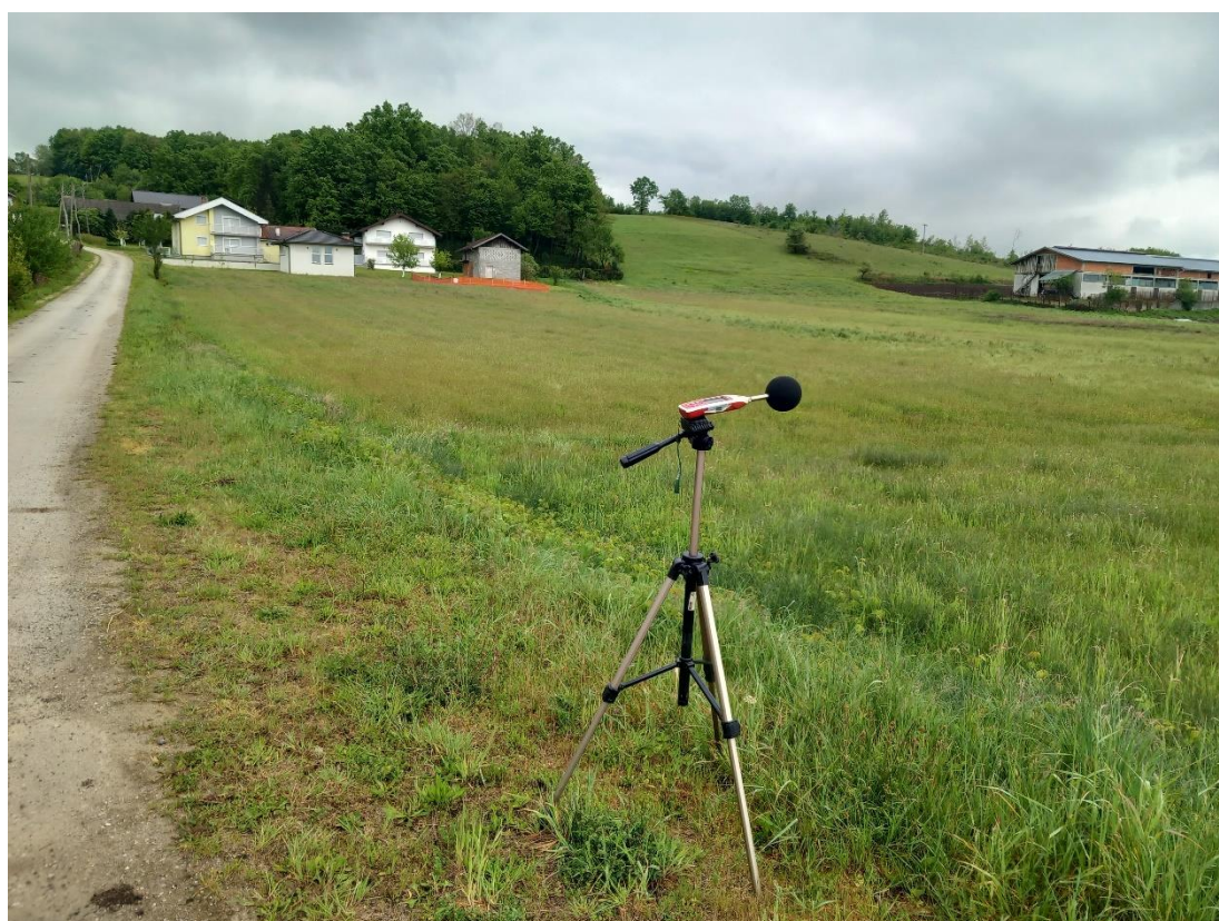
Slika br. 48 Mjerenje buke na predmetnoj lokaciji – MM3
