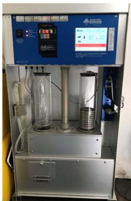
Slika br. 38 Gravimetrijski uzorkivač čvrstih čestica TSP, PM10 i PM2.5
