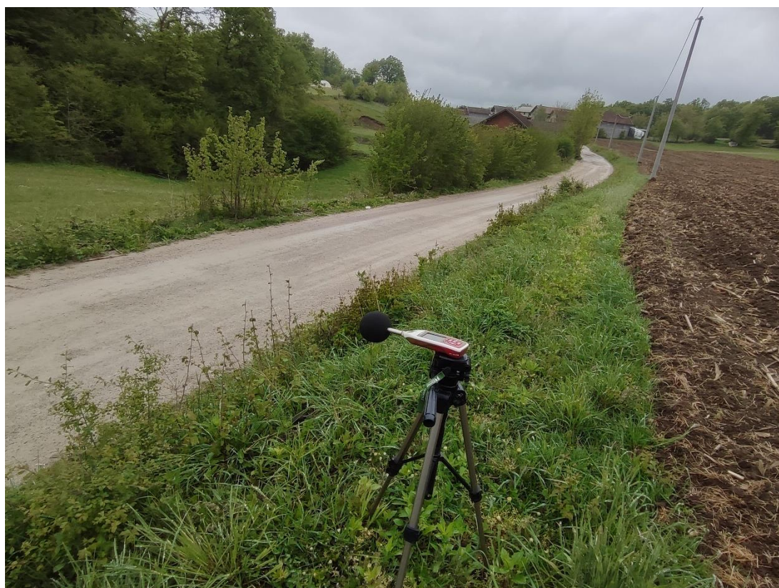
Slika br. 46 Mjerenje buke na predmetnoj lokaciji – MM2
