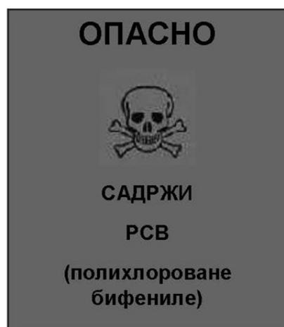
**ОЗНАКА ЗА ОЗНАЧАВАЊЕ УРЕЂАЈА КОЈИ МОЖЕ ДА САДРЖИ PCB**
