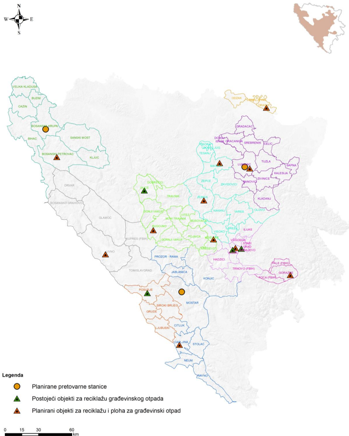
Slika 26. Raspored objekata za upravljanje građevinskim otpadom
