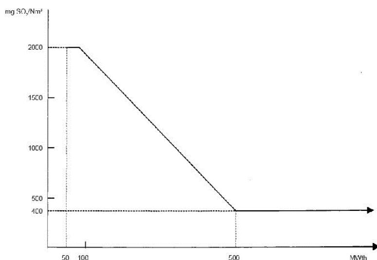
Za postrojenja za sagorijevanje čija je topotna snaga 100-500 MW<sub>th</sub> granična vrijednost emisije SO<sub>2</sub> se izračunava po relaciji:
