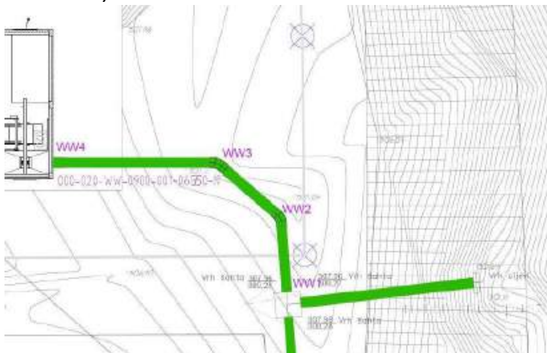
Slika 1. PPOV opća prenosna komora u crtežu kanalizacije
