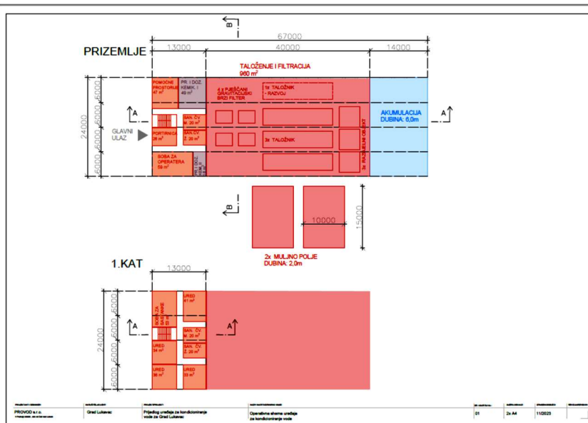
Slika 3: Situacioni prikaz budućeg postrojenja za pripremu sirove i tretman pitke vode
