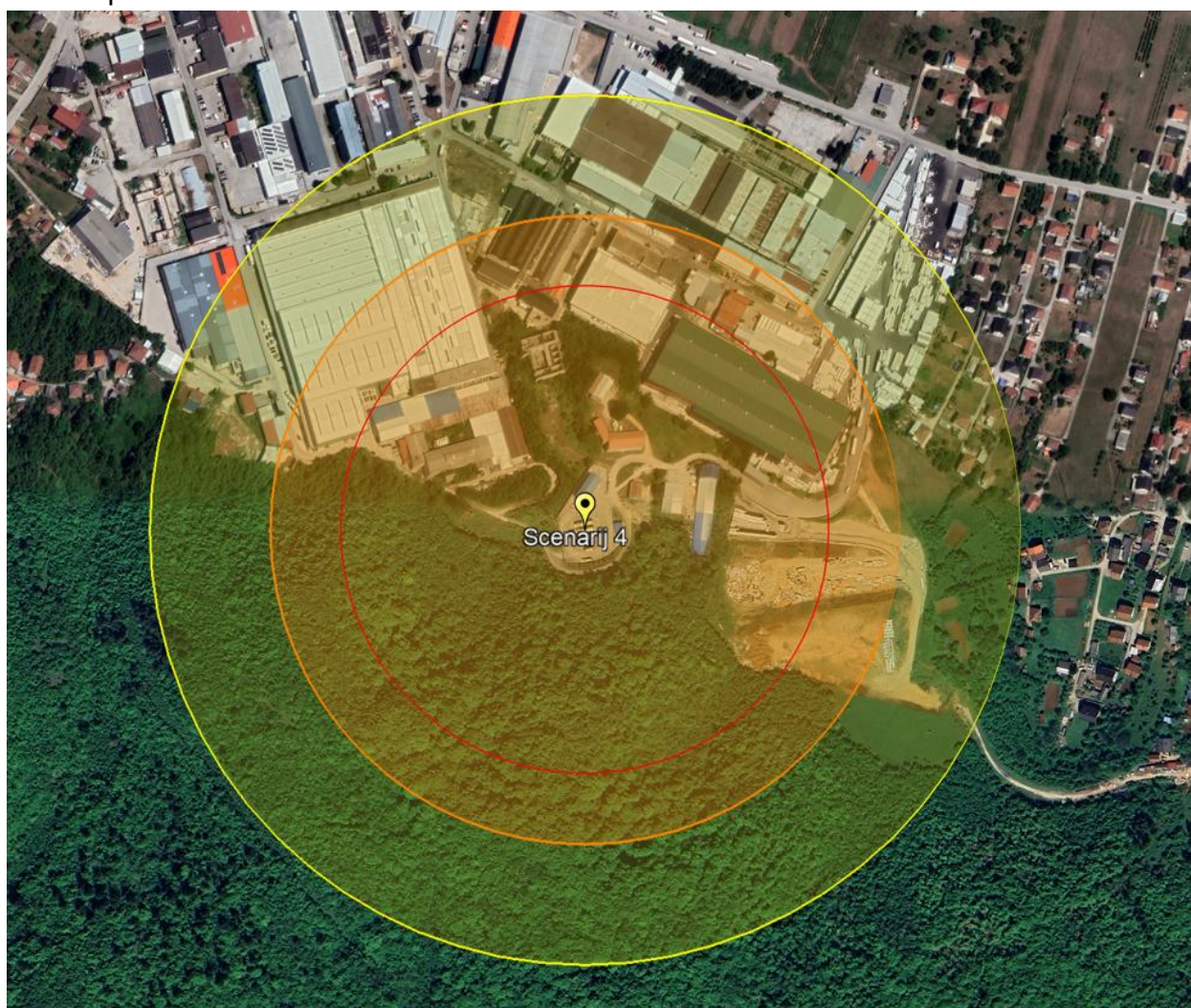
Slika 8. Prikaz zona ugroženosti u slučaju eksplozija ekspandirajućih para vrijuće kapljevine (BLEVE) jednog od nadzemnih spremnika UNP-a 100 m 3
