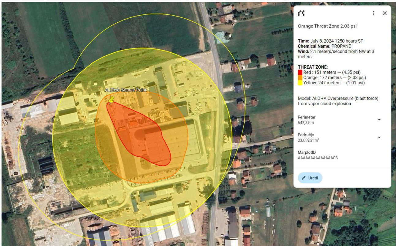
SLIKA 30: ZONE UGROŽENOSTI PRILIKOM EKSPLOZIJE AUTOCISTERNE VOLUMENA 46 M3 PROMJER 5 CM
