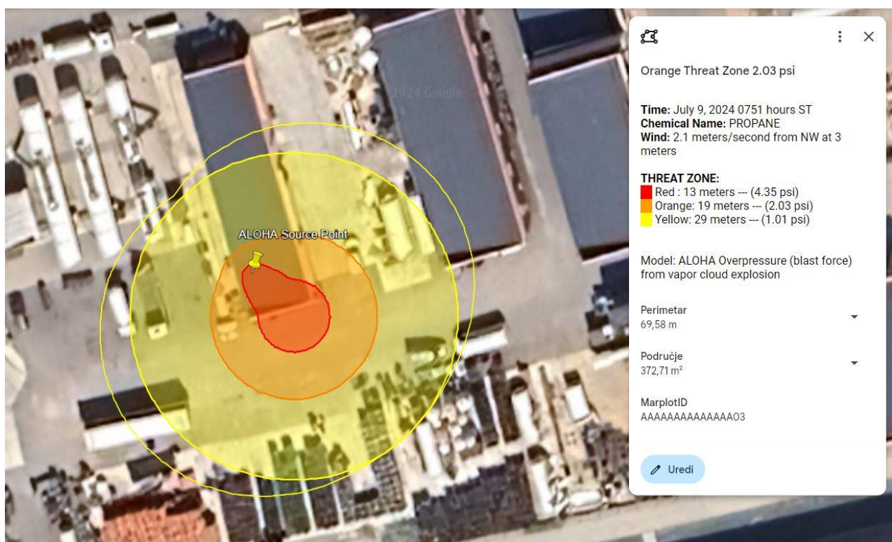
SLIKA 36: ZONE UGROŽENOSTI PRILIKOM EKSPLOZIJE BOCE 10 KG - PUNI PROMJER BOCE
