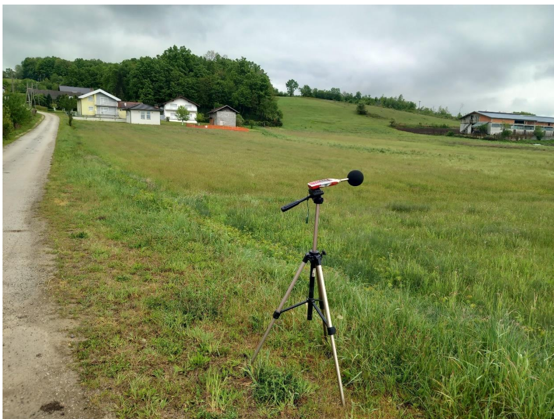
Slika br. 50 Mjerenje buke na predmetnoj lokaciji – MM3
