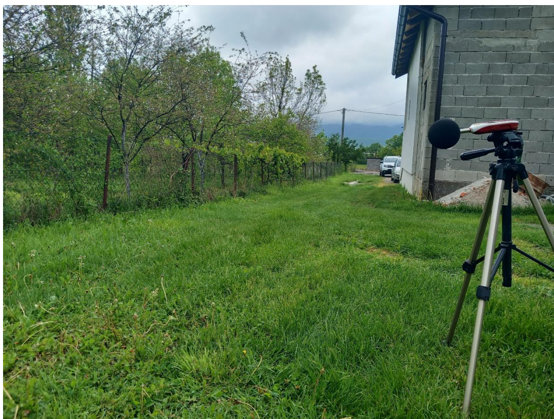
Slika br. 46 Mjerenje buke na predmetnoj lokaciji – MM1
