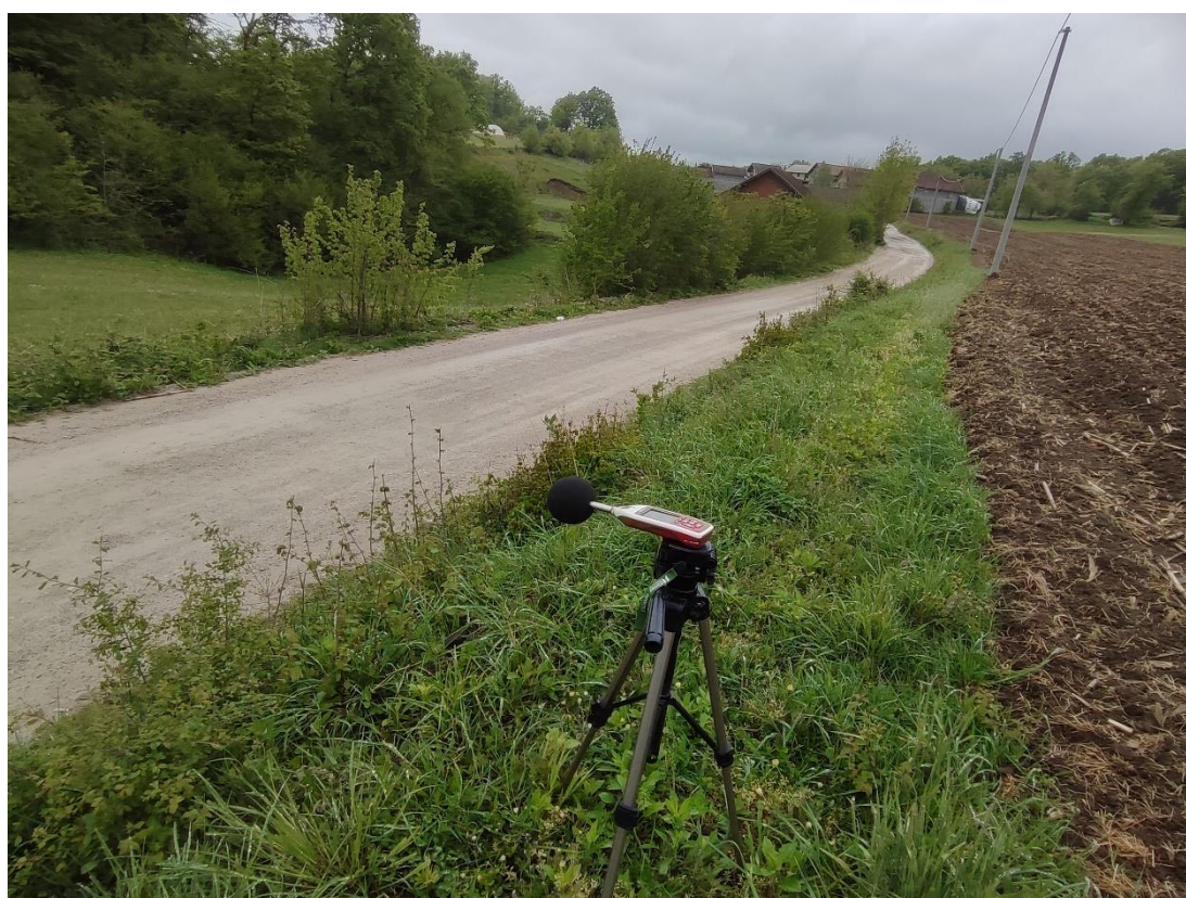
Slika br. 48 Mjerenje buke na predmetnoj lokaciji – MM2
