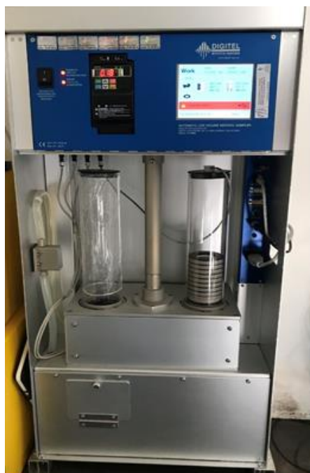
Slika br. 40 Gravimetrijski uzorkivač čvrstih čestica TSP, PM10 i PM2.5
