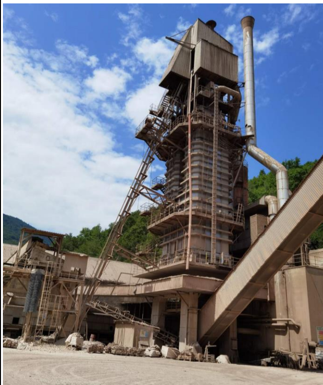
Dvošahtna peć za proizvodnju živog vapna
