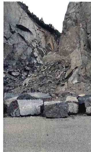
Slika A1.4. Bušenje plitkih bušotina u procesu obrade primarnog „sirovog“ bloka (a) i obradeni komercijalni blok za industrijsku preradu na površinskom kopu „Suljo Čilić“
