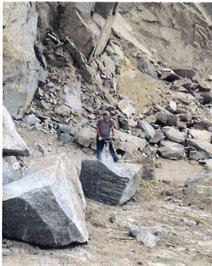
Slika A1.4. Bušenje plitkih bušotina u procesu obrade primarnog „sirovog“ bloka (a) i obradeni komercijalni blok za industrijsku preradu na površinskom kopu „Suljo Čilić“
