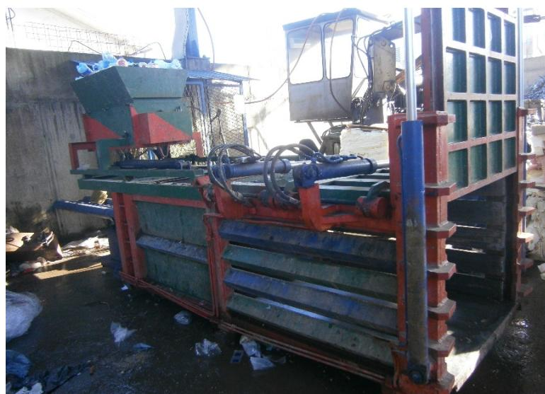
Slika 2. Hidraulična presa za papir
