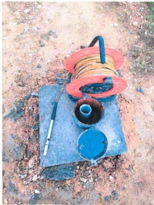
Slika 12. Mjerenje nivoa podzemnih voda iz ugrađenog pijezometra na lokaciji bušotine B2
