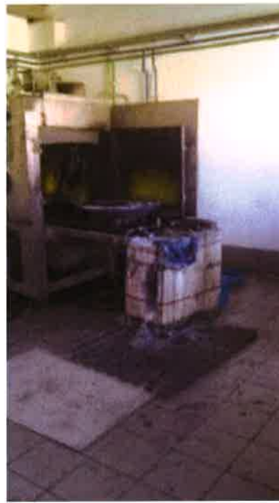
Slika 11. Uređaj za uklanjanje nečistoća uz pomoć sode i pjeskarenje
