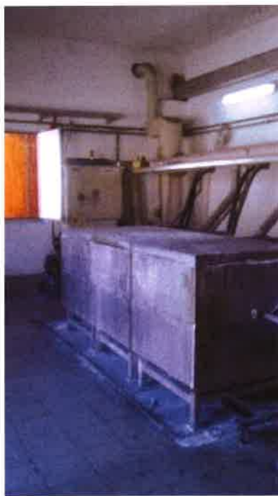
Slika 11. Uređaj za uklanjanje nečistoća uz pomoć sode i pjeskarenje
