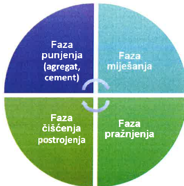
Slika 4 Osnovne faze proizvodnje betona
