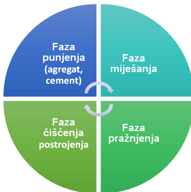
Slika 3 Osnovne faze proizvodnje betona
