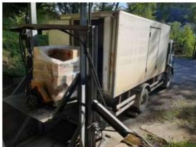
Slika 10. Hidraulična platforma za utovar eksploziva
