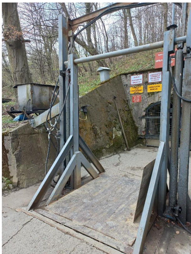
Slika 10. Hidraulična platforma za utovar eksploziva
