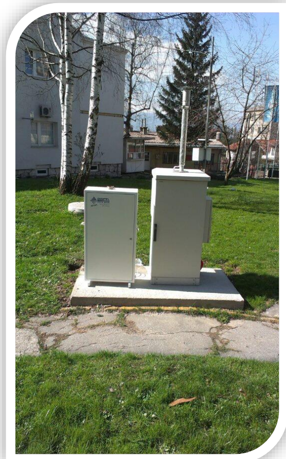
Slika: analizator i uzorkivač PM čestica na stanici Bjelave Sarajeva:
